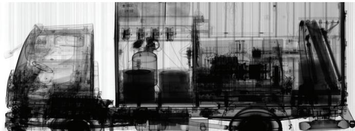
PORTAL-BETA P02-2W は貨物を積んだ車両／トラックの高スループットX線検査用に設計された独自のデュアルウェイマルチエネルギーポータルです。プラスチック武器および爆発物、麻薬、放射性物質を含む密輸品を検出できます。主なシステム構成部品は、高エネルギーX線ビームを生成するX線発生器と高感度L字型検出器です(各検査チャンネルには数台の検出器が配され、スループットを増大させています)。デュアルウェイ(チャンネル)設計により、本システムは市場最高のスループットを獲得し、また、シングルやマルチウェイシステムではできない、あるいは必要とされる以上の高いスループットを実現できます。PORTAL-BETA P02-2W は強力な侵入深さと低放射線量を兼ね備えています。出力エネルギーを迅速に変更できる独自の周期的加速器を用いることにより、本システムは最低線量でトラックの運転手がいる運転室に侵入し、その後は数マイクロ秒で高線量モードに切り替えられます。
